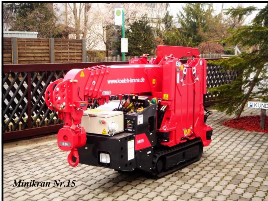
**Der Minikran Nr. 15** hat eine maximale Traglast bis zu **3,0 to**, bei einem Eigengewicht von **2090 kg**. Die Durchfahrtsbreite von **600 mm** ist schmal genug, um durch eine schmale Normtüröffnung zu fahren.
